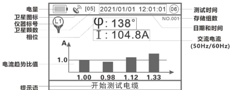
测试界面上方分别显示电池电量、卫星连接图标、卫星颗数以及日期和测试时间，在开机时下方提示语会提示用户到空旷露天的地方搜星，在
