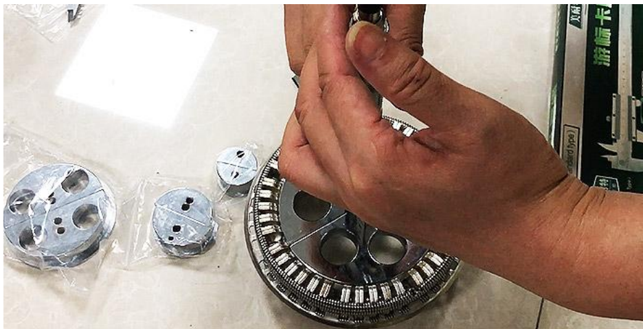
第六步：将传感器前端的模拟触头测量工装插入梅花触头内部。（见上图）
