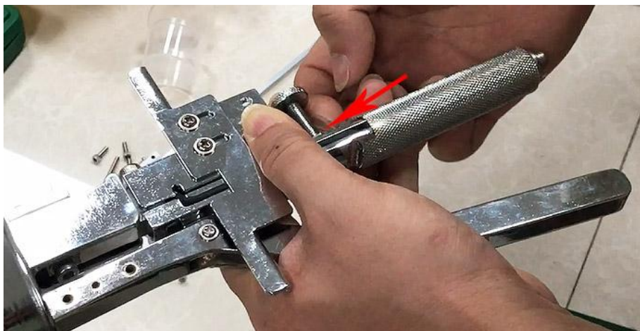
第五步：调节螺钉，稳固开距。（见上图）
