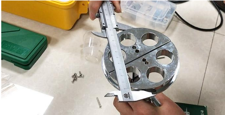
第四步：测量模拟触头工装的直径（并确保模拟触头撑开直径达到要求的间距）（见上图）
